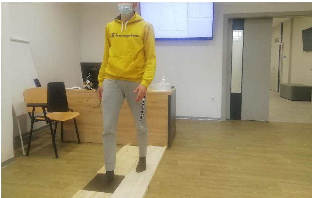
Slika 7. Platforma za mjerenje sila reakcija podloge – primjer s vježbi
